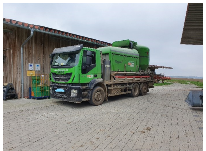
Abbildung 5: Mobile Mahl- und Mischanlage. Bild: Christopher Lindner
